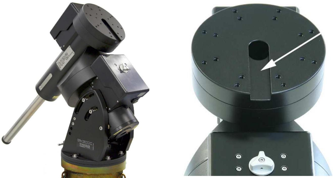
**Abb. 4.17: Nur in der Default-Parkposition dürfen Gegengewichte und Teleskop montiert oder abgenommen werden. Achten Sie darauf, dass die Markierungsstriche einander gegenüber stehen**
