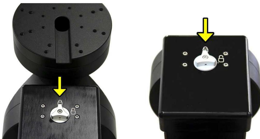
Abb. 4.4: Einkuppeln der Schnecken in RA bzw. DEC
