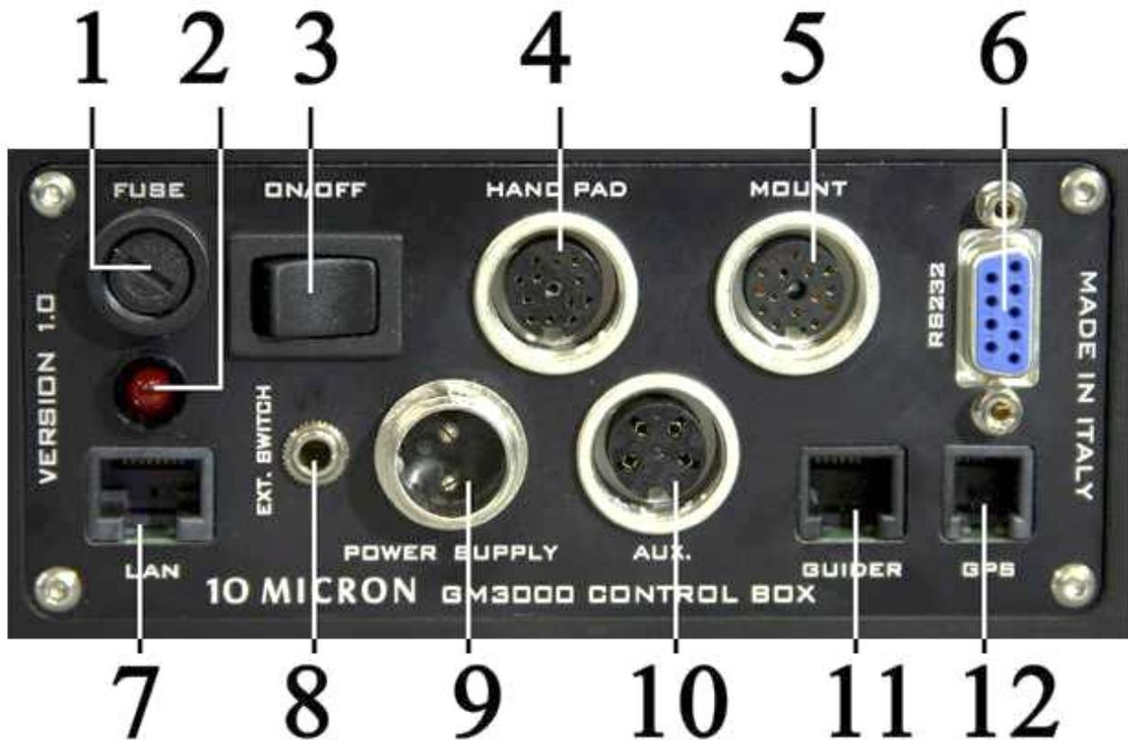
Abb. 5.1: Anschlüsse der Kontrollbox
