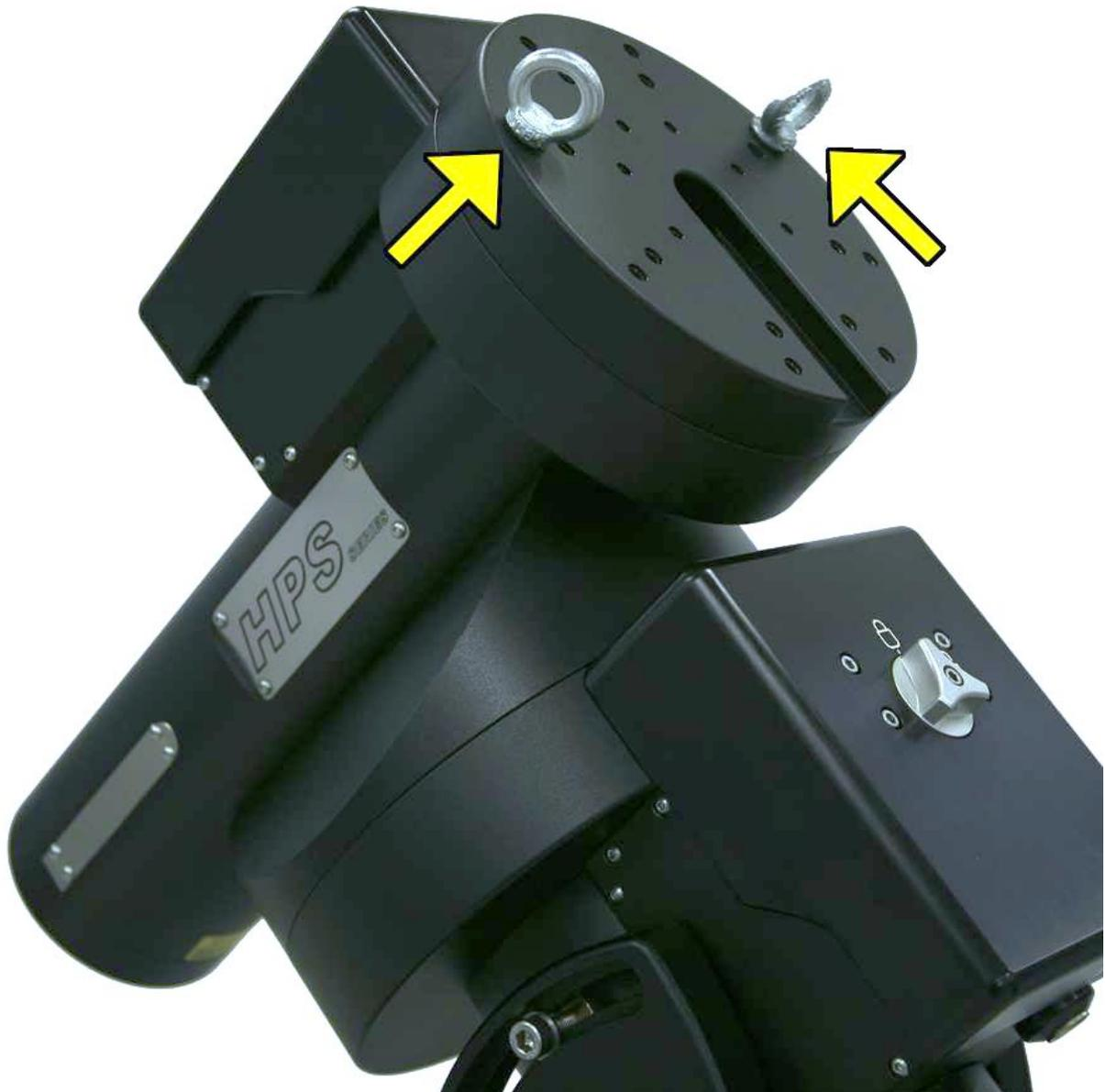
Abb. 4.5: An diesen Stellen sollten die beiden Lastösen eingeschraubt werden.
